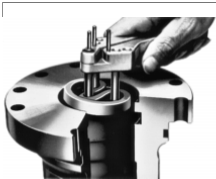
Рис. 6.22 Монтажная оснастка для уплотнений штока
