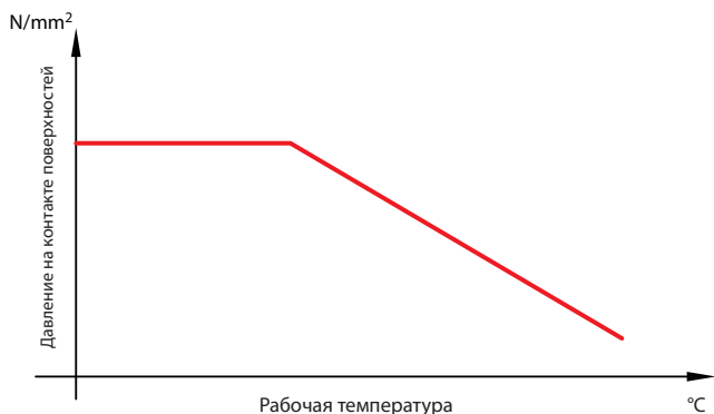
Рисунок 34 Зависимость давления на контакте поверхностей от рабочей температуры для направляющих элементов из POM
