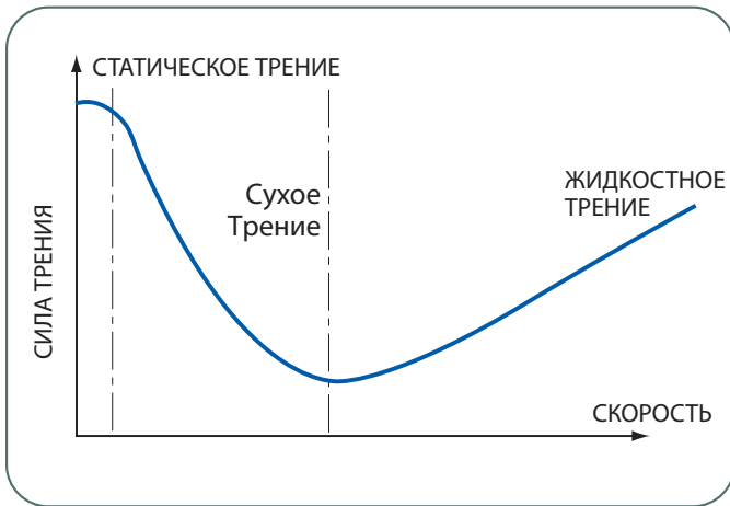
Рисунок 25 Зависимость силы трения от скорости скольжения
